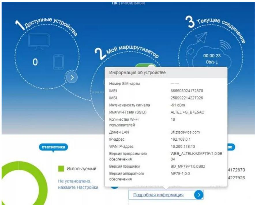
3. Направьте антенну в сторону предполагаемой базовой станции. Поворачивайте устройство, пытаясь добиться наилучшего показателя интенсивности сигнала, он должен стремиться к нулю.
